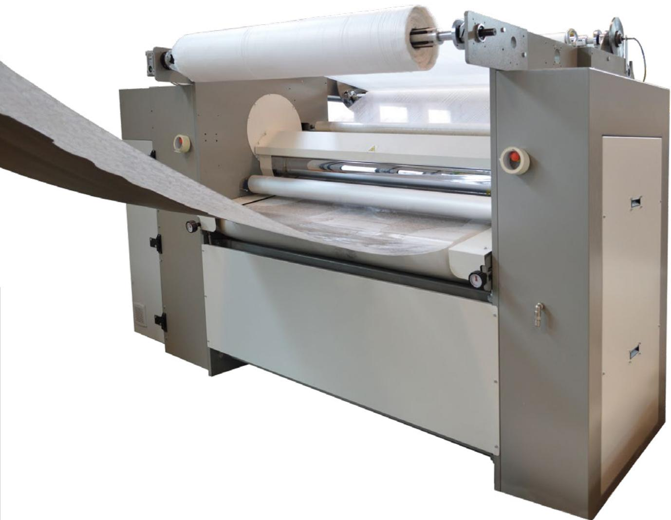
Esta máquina é a solução profissional para a aplicação de película transfer sobre pele e tecido e para os acoplamentos em contínuo também de películas de dupla proteção.
